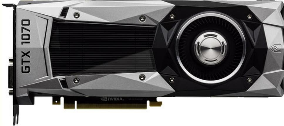
GTX 1070 оснащена 1920 ядрами CUDA, 120 блоками текстур и 8 Гбайт памяти GDDR5 на 256-разрядной шине. К тому же, благодаря TDP 150 Вт GTX 1070 сохраняет относительно скромные требования к блоку питания - достаточно мощности 500 Вт и одного восьмиконтактного разъёма.
