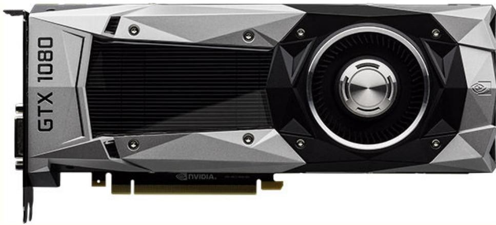
Подобрать карту для игр в 4K трудно. Месяц назад Nvidia GeForce GTX 1080 считалась лучшим решением, а чтобы получить больше скорости, требовались многочиповые решения. Карта с графическим процессором GP104 имеет 2560 ядер CUDA, 160 блоков обработки текстур и 8 Гбайт видеопамяти GDDR5X с 256-битной шиной. Она обладает превосходным уровнем производительности, имея тепловой пакет всего 180 Вт.
