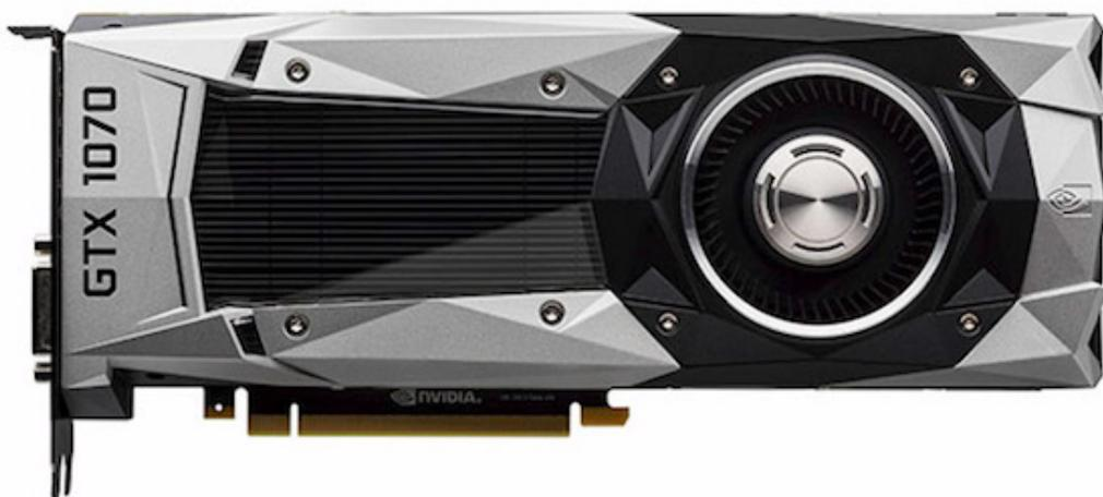
У Nvidia GeForce GTX 1070 1920 ядер CUDA, 120 блоков текстурирования, 8 Гбайт памяти GDDR5 на 256-битной шине. К тому же, TDP всего в 150 Вт позволяет удерживать требования к питанию на разумном уровне – Nvidia рекомендует блок питания мощностью 500 Вт с одним восьмипиновым коннектором.
