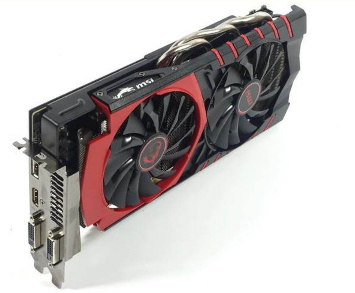
AMD не упускает возможности продать устаревающие чипы. На этот раз речь идет об AMD Radeon R9 380 на базе GPU Tonga, который теперь называется Antigua. Когда-то этот графический процессор использовался в видеокарте Radeon R9 285. Сегодня мы видим тот же чип с 1792 шейдерами, 112 блоками текстурирования и 32 ROP
