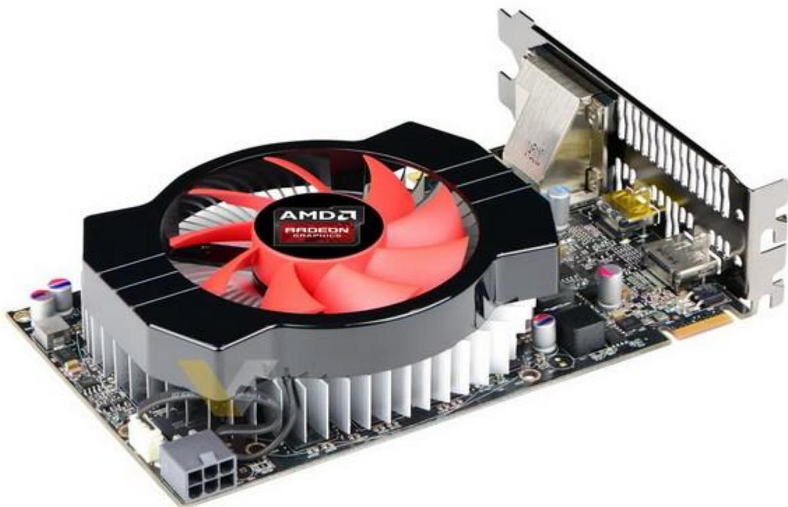
Radeon R7 360 построена на базе графического процессора Bonaire, знакомого нам по видеокарте Radeon R7 260. 360-я немного быстрее благодаря более агрессивному разгону ядра и видеопамяти GDDR5. Не стоит ожидать от 360-й уровня производительности AMD R7 260X, поскольку последняя имеет больше шейдерных ядер и блоков обработки текстур.
