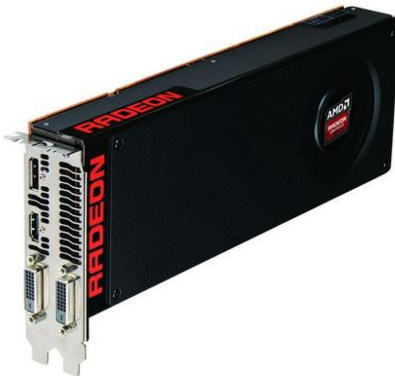
AMD R9 390 сейчас стоит дешевле Radeon R9 290X. И хотя GPU в R9 390 имеет меньше шейдерных ядер, чем предшественник, более высокая тактовая частота GPU и памяти, а также 4 Гбайта GDDR5 позволяют вытеснить 290X с ее позиций.
