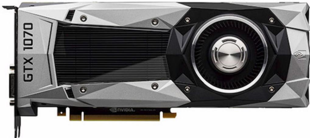
У Nvidia GeForce GTX 1070 1920 ядер CUDA, 120 блоков текстурирования, 8 Гбайт памяти GDDR5 на 256-битной шине. К тому же, TDP всего в 150 Вт позволяет удержать требования к питанию на разумном уровне – Nvidia рекомендует блок питания мощностью 500 Вт с одним восьмипиновым коннектором.
